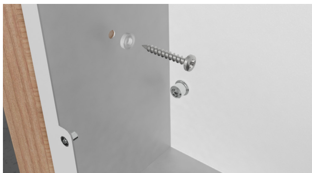
Kaapin kiinnitys koolattuun seinään.
