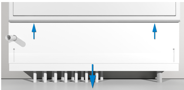
LK Sokkelin asennus.
