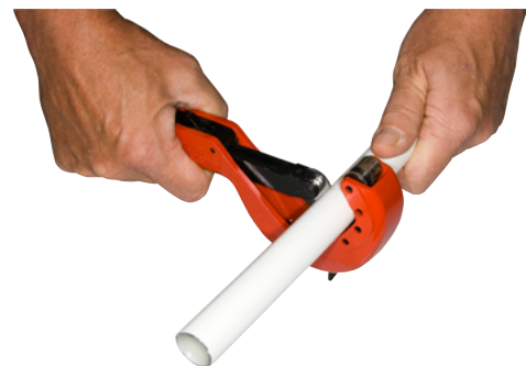
Katkaisu putkileikkurilla, joka on varustettu pyöröterällä muoviputkea varten, tai putkisaksilla.
