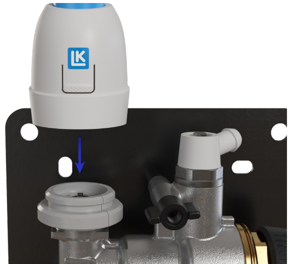
Vaihe 4: Asenna toimilaitte harmaaseen adapteriin painamalla. Kiinnittymisestä kertoo klik-ääni, kun adapteri on oikein asennettu.
