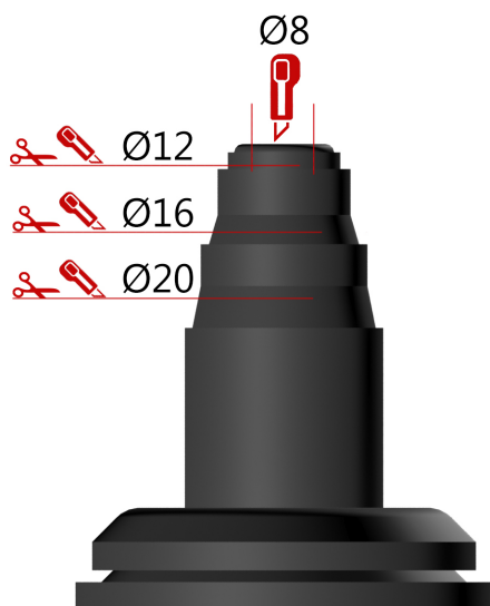
Putkiläpiviennin katkaisu lattialämmitysputkille.
