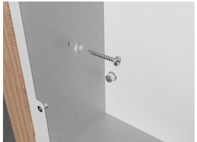
Kaapin kiinnitys koolattuun seinään
