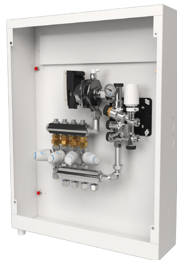
Esimerkki täydellisestä asennuksesta, jossa LK Miniseoituryhmä, LK Minijakotukki ja LK Thermostaattiventtiiliarja Mini asennetaan LK Miniseoituryhmäkaappiin XL.
