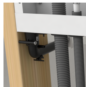
Viemärointikulma liitettynä suoraan kaapin ylivuotoputken kaulukseen päättyy samaan tilaan kuin kaapin huoltoaukko tai vaihtoehtoisesti sen takana olevaan tilaan.
