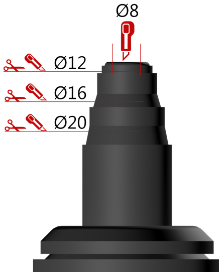
Putkiläpiviennin katkaisu lattialämmitysputkille.
