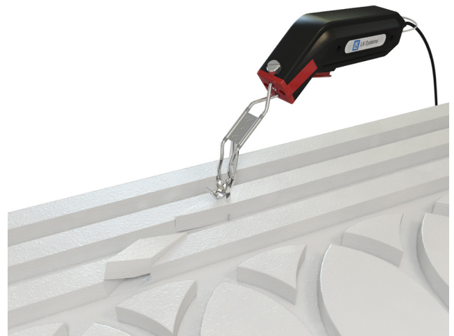
EPS-solumuovilevyn uritus LK Lämpöleikkuri 90 W -laitteella.
